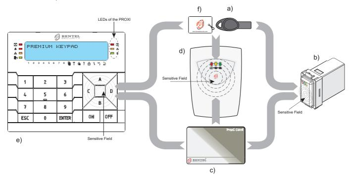
Figure 3 a) SAT Digital key, b) ECLIPSE2 key reader, c) PROXI-CARD, d) PROXI reader, e) PREMIUM LCD key-pad, f) Miniproxi.
